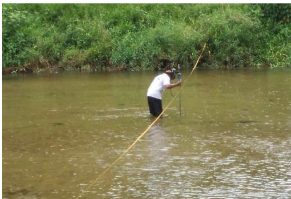
Figura 4.4 - Medição de vazão com Flowtracker no Rio Taquari
