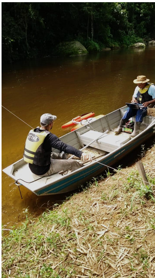
Figura 4.3 - Medição de vazão com RiverRay no Rio Mambucaba
